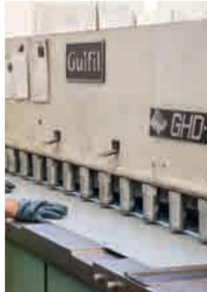
Corte de Chapas Metálicas por Guilotina até 10 mm de Espessura.
