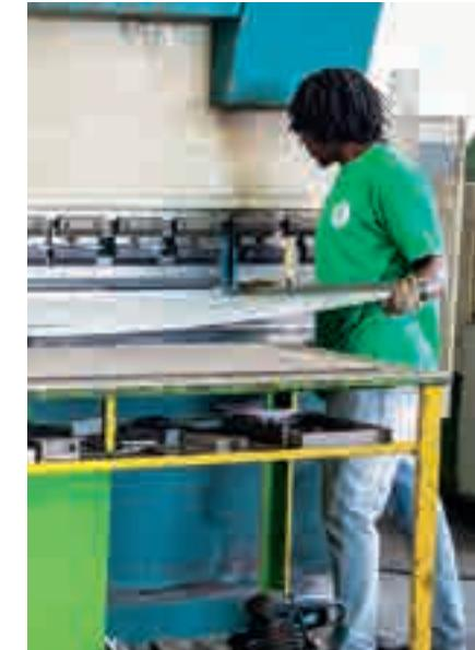
Quinagem de Peças até 3000 mm de comprimento e 10 mm de espessura. Diferentes matrizes e punções permitem obter diferentes ângulos e raios de quinagem.
